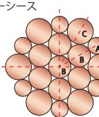
3E撚り構造は同心撚り配列構成の一括集合撚り線導体で、3種類の異なる素線径を配置する事により、撚り線配列を緻密化。導体構成の細分化が可能となり、導体特性値の向上を図ります。
