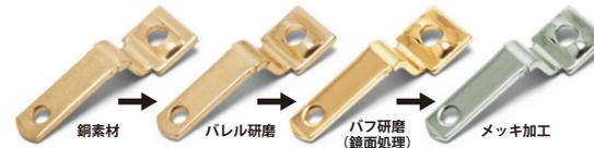
高度なエンジニアリングによってひとつひとつ打ち抜かれた電極は、ミクロン単位の精度を極めた素材に表面処理を施すことでスムーズな挿抜と高い導電効率を確保し、更に各モデルの性能を特徴付けます。
