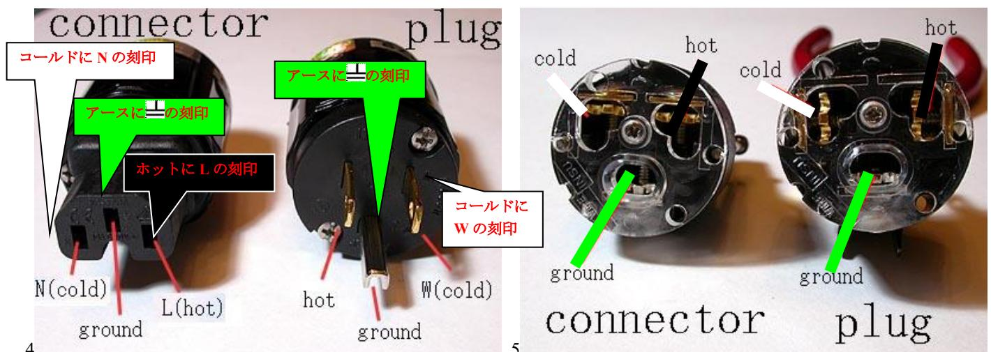
4.5.電源プラグおよびIECコネクターの極性。4.外部電極の極性。5.内部電極の極性。
