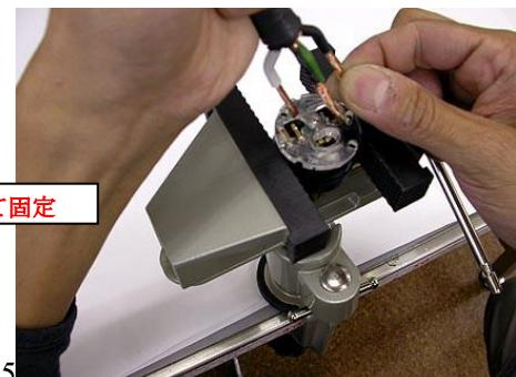
33. プラグ・コネクター側面の 3 か所のネジをプラスドライバー（大）で緩め、クランパーを広げる。
