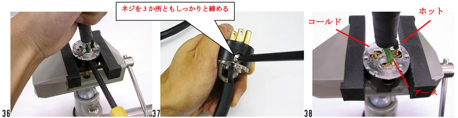
36. アース電極のネジをプラスドライバー（大）で締める。
