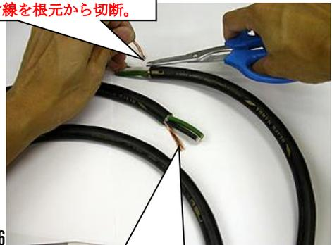
14. 15. 紙の介在を取り、さらに半透明の介在ビニルチューブを根元からハサミで切断する。
