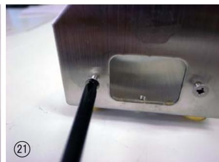
⑲～⑳ ナットをラジオペンチで挟み、ドライバーで皿ネジを締めて、コンセントを固定する。
