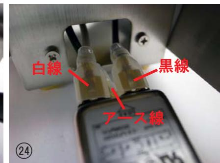
㉒ シャーシの蓋をシャーシ本体に被せ、インレット取付穴から内部配線の先端を引き出す。
