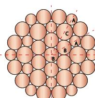
3E撚り構造は同心撚り配列構成の一括集合撚り線導体で、3種類の異なる素線径を配置する事により、撚り線配列を緻密化。導体構成の細径化が可能となり、導体特性値の向上を図ります。
