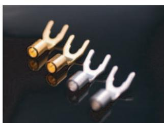
2mm厚の無酸素銅の板材より形状を打ち抜き加工し、表面平滑処理を行った後S R Y Tは厚肉の銀メッキをかけ、さらにはパラジウムメッキを施し、G T Yは厚肉24K金メッキを施しました。
