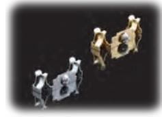
**ねじ・接合部:**全てのネジはステンレス製ビスを使用。剛性の高いステンレスネジはトルクをかけすぎてねじ山が潰れる、頭が取れるといったトラブルはありません。また、最大ケーブル取り付けサイズは5.5sqで抜群の作業性を誇ります。安全面を十分考慮した結果、刃受け部分とケーブルの引っ張り強度は30kg以上で、ちょっとした引張りでも抜けてくるようなことはありません。電気安全法をクリアし、アメリカUL安全規格も申請中(7/06'現在)です。また、環境面でも使用する全ての部材は欧州Rods指令をクリアした素材を使用しています。
