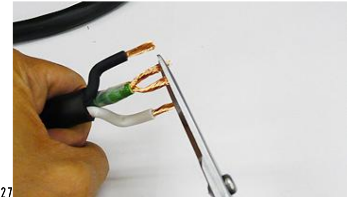
25. 2股に分けたアース線に、一番細いマイナスドライバーの軸を挟み、U字型になるように導体の方向を整える。
