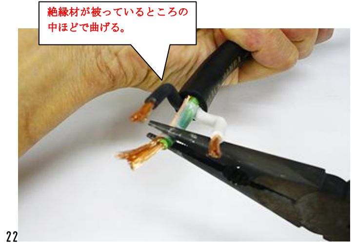
21. アース線をホット線・コールド線の上にまたがせてから、根元から放射状に曲げ広げる。
