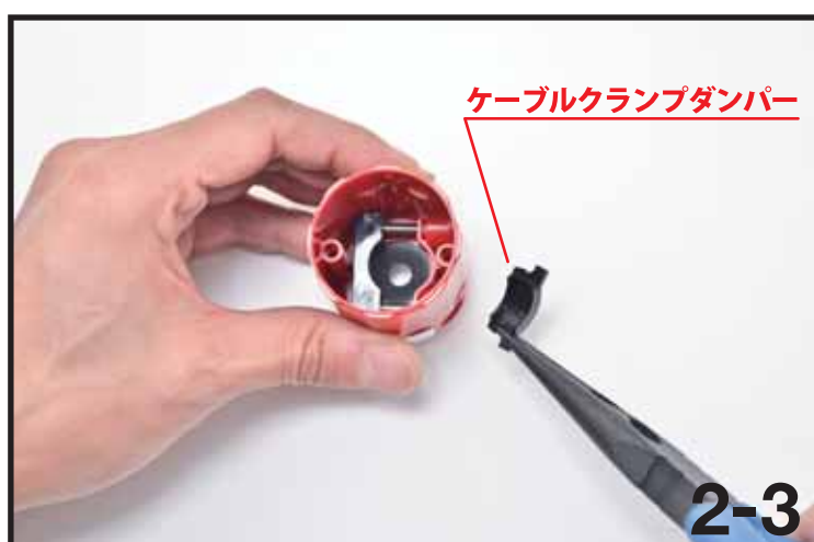
2-3：カバー内のケーブルクランプダンパーをラジオペンチで引き抜きます。
