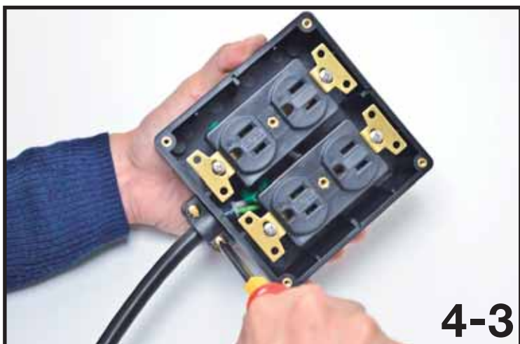
4-3：ケーブルグランドを締めてケーブルを固定します。
