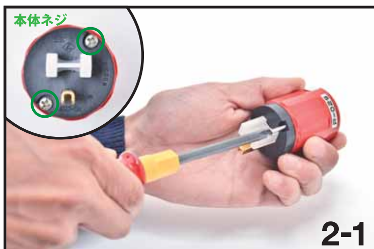
2-1：電源プラグのプラグ本体のネジをドライバーで緩め、本体からカバーを外します。
