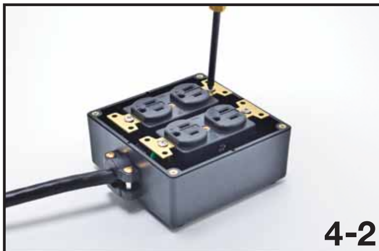
4-2：コンセントカバーの穴の位置に合うように微調整しながらコンセントを銀色の M4 ネジでコンセントボックスのポストに固定します。
