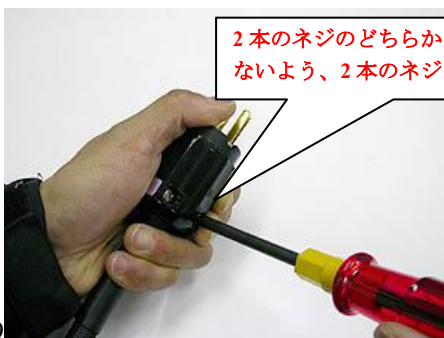
19 プラグカバーのネジを締めて、ケーブルを固定する。
