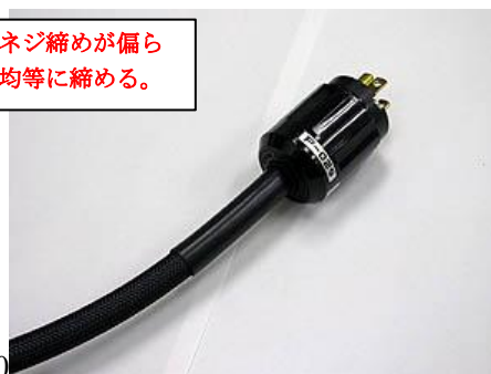
19 プラグカバーのネジを締めて、ケーブルを固定する。
