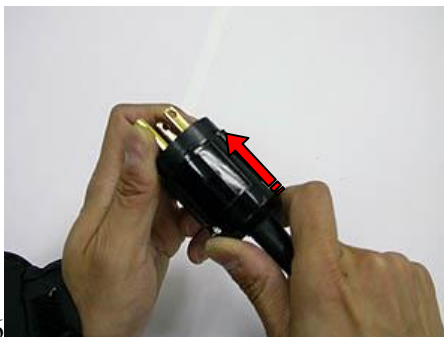
16 プラグ本体の凹みにプラグカバー内側の突起が嵌るようにして、プラグ本体にプラグカバーを被せる。
