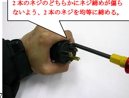
16 プラグ本体の凹みにプラグカバー内側の突起が嵌るようにして、プラグ本体にプラグカバーを被せる。
