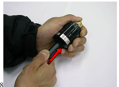
16 プラグ本体の凹みにプラグカバー内側の突起が嵌るようにして、プラグ本体にプラグカバーを被せる。
